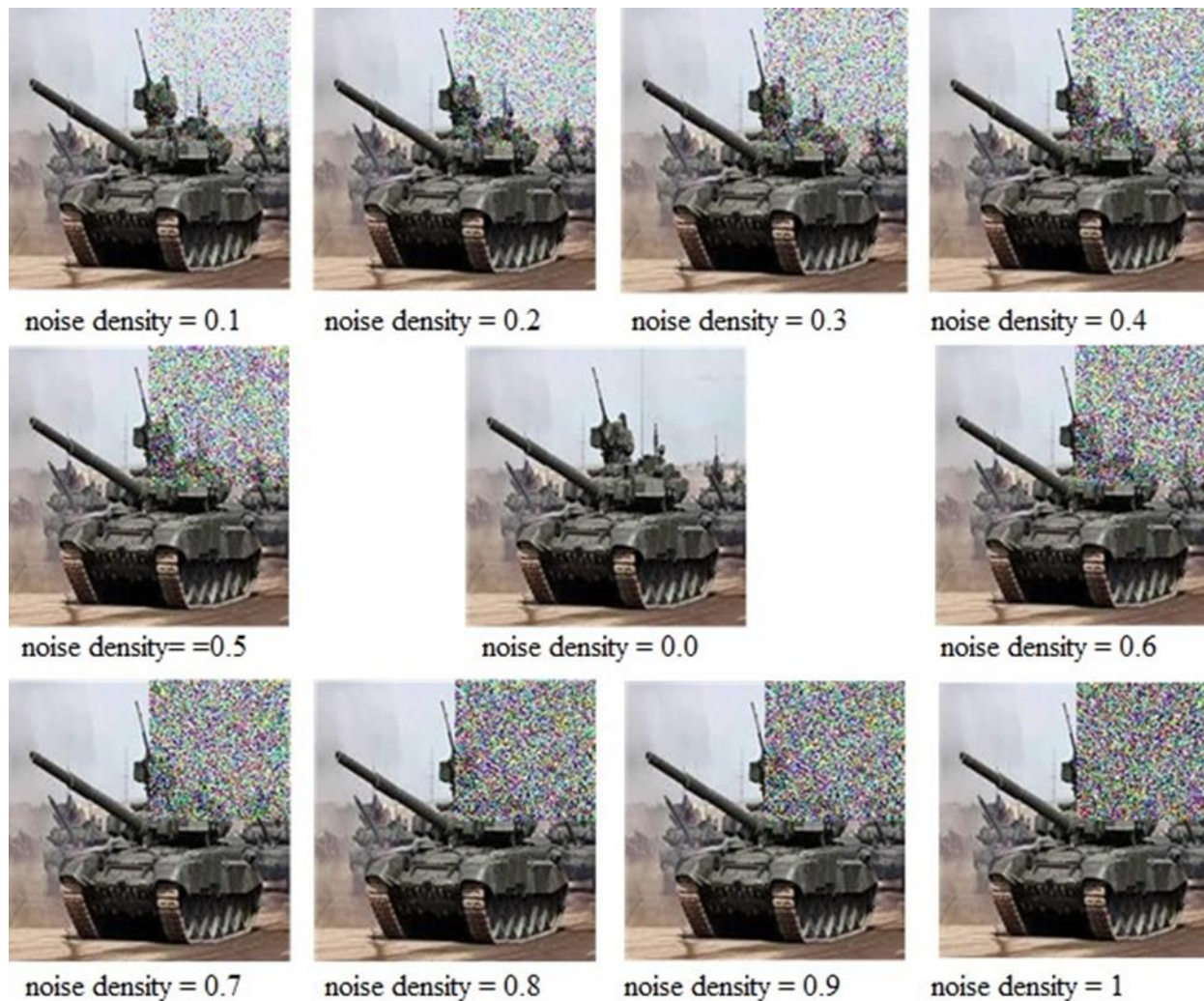
Фиг. 4.16. Варианти на закриване Quad2_TopRight за изображение на обект от клас „танк“ изпълнени чрез прилагане на функцията salt&pepper (импулсен шум) с различна плътност на шум ( noise density ).
