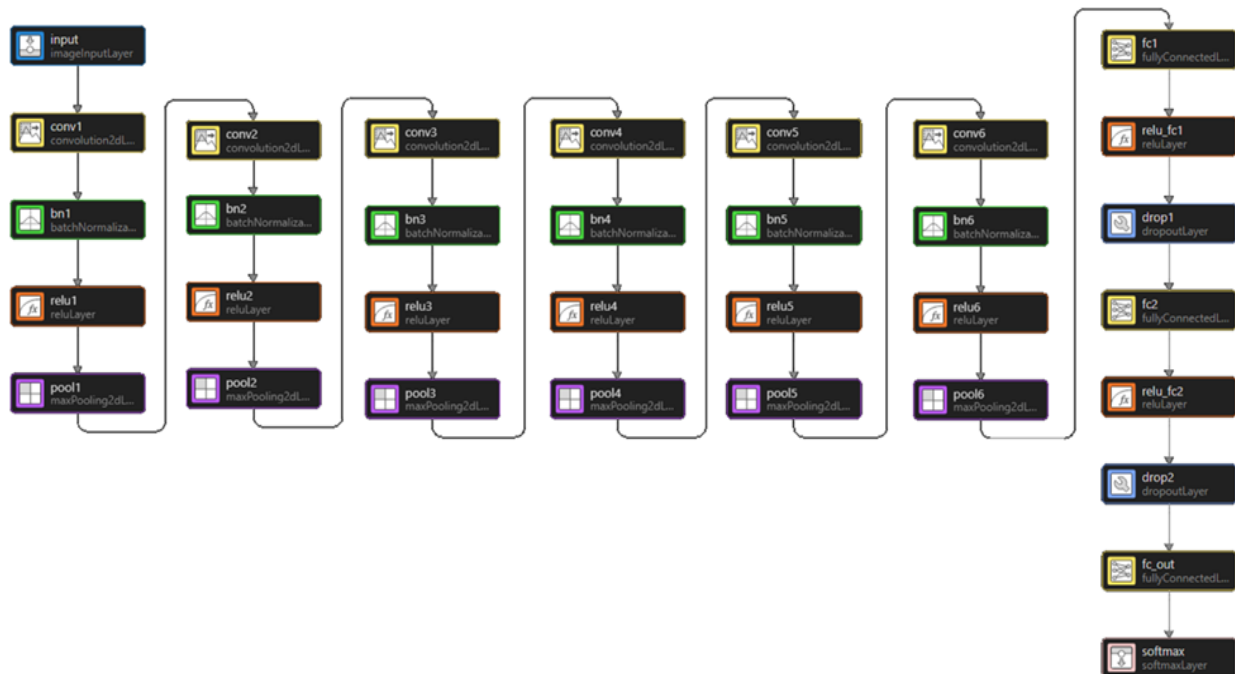
Фиг. 4.9. Схема на реализираната CNN с шест конволюционни блока (без класификационен слой).
