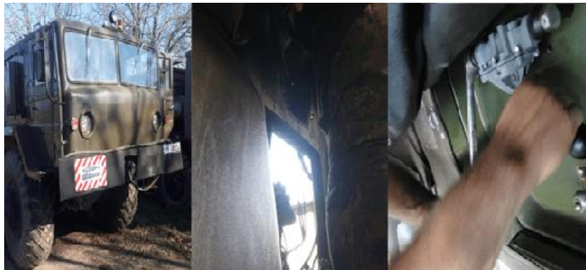
Фиг. 4.5. Поставяне на възстановените образци РНМ-1к върху горивната система на МАЗ–537Г.
