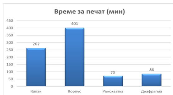
Фиг. 4.8. Време за 3D печат на отделните компоненти от РНМ-1к, изработени чрез FDM технология.
