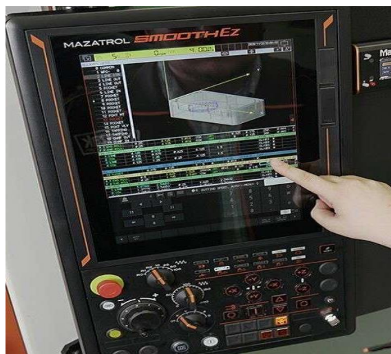
Фиг. 3.9. ЦПУ – център MAZAK(Smooth technology) – задаване на параметри програматор.
