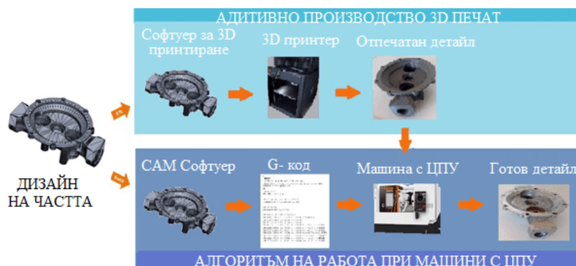
Фиг. 4.7. Визуализация на технологичния алгоритъм при 3D печат и ЦПУ обработка.
